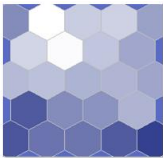
多晶片经 PECVD 镀膜后绒面的二维反射率, 不同颜色代表不同反射率。根据二维反射率, 可以衡量电池片的全片平均反射率和不均匀度 ( R9000 测量软件 Mapping 功能测量截图 )。
